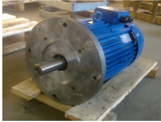
Motor cu 2 turatii si cu flansa si arbore speciale executate dupa desenul clientului
