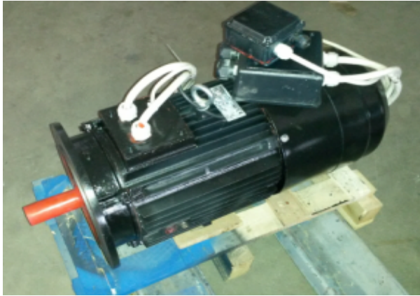
Motor electric cu 2 turatii, IP56, cu rezistente anticondens si cu termistori, cu frana si cu cutiile de borne de alimentare separate de motor
